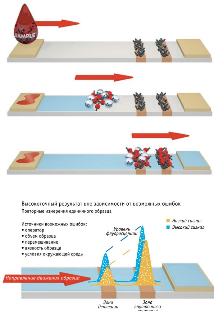
Приборы RAMP измеряют интенсивность флуоресценции в зоне детекции и в зоне внутреннего контроля. Соотношение этих сигналов пропорционально концентрации аналита в исследуемом образце.
